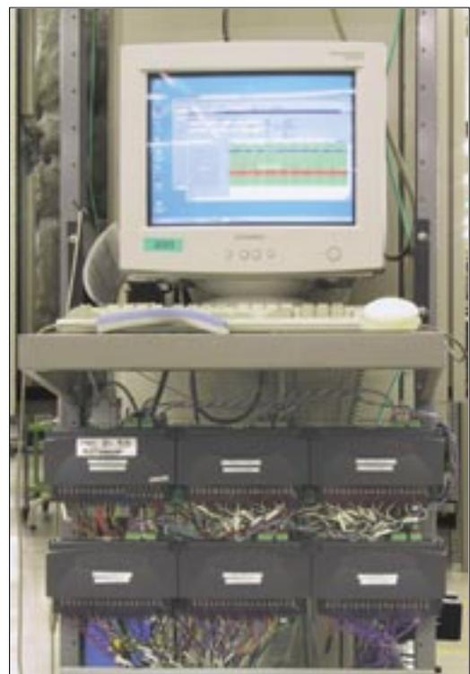
図3 PCレコーダを使った連続通電検査装置
