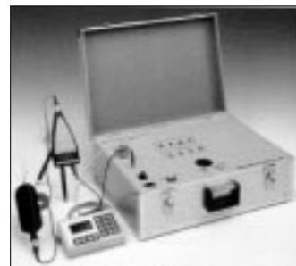
図1 携帯型実音モニタリング装置
