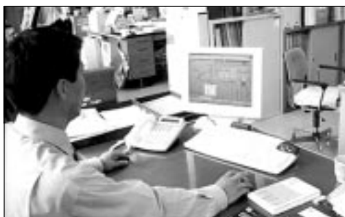
図3 役場内のLANに接続されたパソコン。このパソコンで浄水場にある監視画面を見たり、操作したりすることができます。
