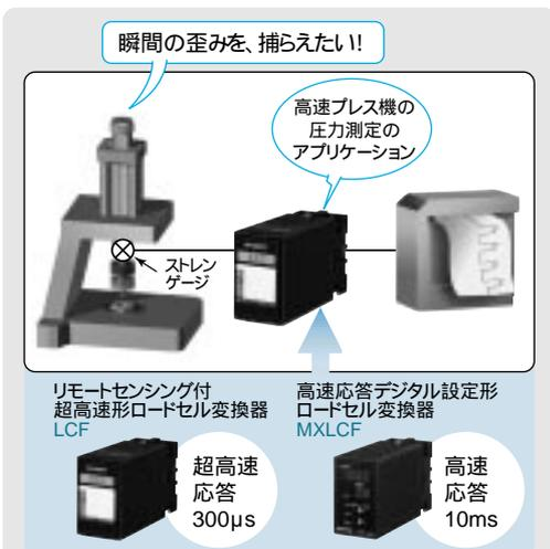
図4 アプリケーション例 (高速プレス機の圧力測定アプリケーション)
