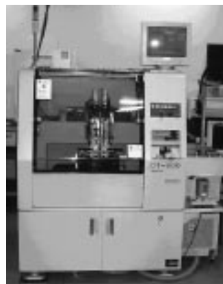
図2 クリ-ムはんだ供給装置 (Dispenser DT-300-2)
