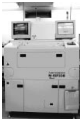
図6 はんだ付け形状の検査装置 (PCB 3D SOLDER PROFILE INSPECTION MACHINE M-ISP33B)
